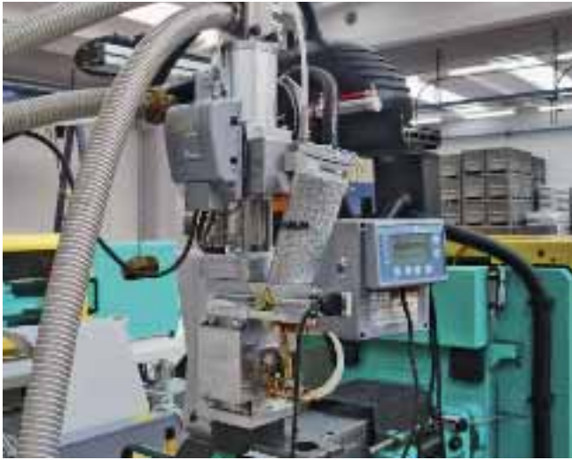
Esempio d'applicazione: il dosatore volumetrico MDP della Piovan installato su di una pressa. All'interno della tramoggia trasparente sono visibili i granuli di colorante.
