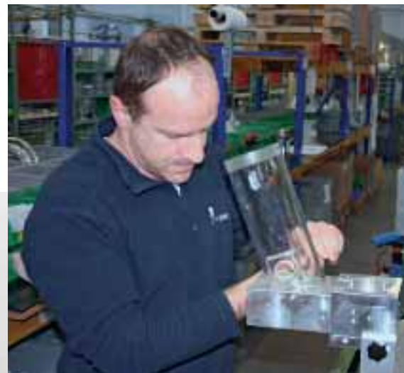
Un operatore specializzato della Piovan esegue il montaggio della tramoggia in Plexiglas sul dosatore volumetrico MDP.
