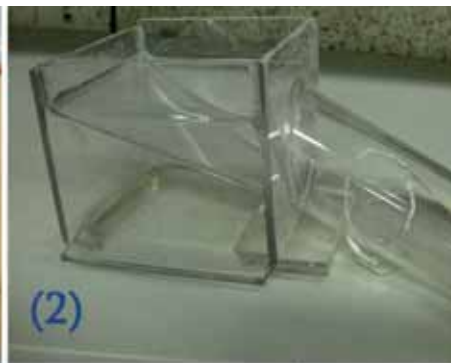
(1) Chitarra elettrica con struttura realizzata in plexiglass. (2) Convogliatore di scarico saldato in PETG (materiale alimentare). (3) Altri componenti realizzati dalla Fedele Boschello, immagazzinati e catalogati secondo specifici codici.
