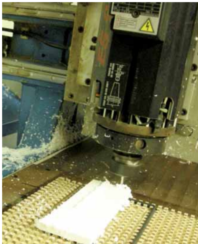
Lavorazione al pantografo verticale di una piastra in PETP naturale.
